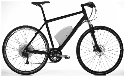
A hátsó kerékagyba integrált elektromotor
